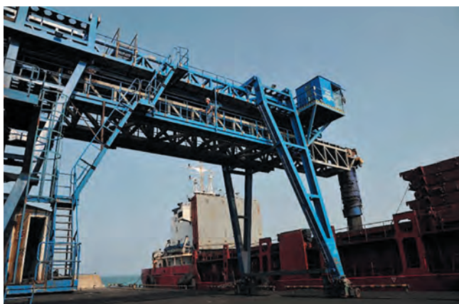
Погрузочная машина мощностью 2,5 тыс. т в угольном морском порту Шахтерск
