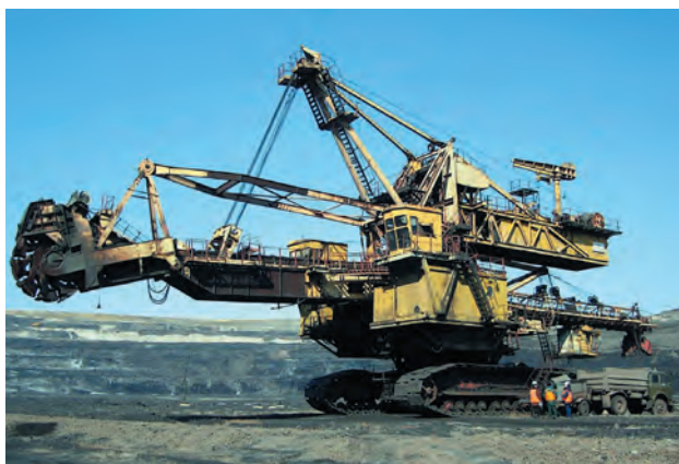
Роторный экскаватор ЭР-1250 18/1,5 выпущенный в 1979 г. на ПО «Донецгормаш» с проектной производительностью 1250 м 3 /ч. За время работы на карьерах Экибастуза до 2007 г. наработал 33,9 млн м 3 породы
